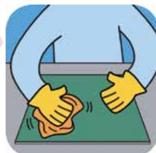
**3** Coloque o Mirox Premium, Lacobel, Lacobel T e Matelac em uma superfície macia, limpe o verso (lado da tinta) com um pano limpo e umedecido em água morna para retirar todas as impurezas, e com um outro pano seco retire o excesso.
