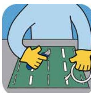
**5** Cole o Mirox Premium, Lacobel, Lacobel T e Matelac na área de aplicação. Se necessário, utilize calços, espaçadores ou fitas dupla face para manter o vidro no local. Faça alguns ajustes caso necessário. Cuidado, pois quando colocado na parede, não há mais como movimentar o vidro.
